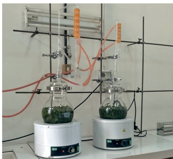
Figura 12.1 - Distillazione in corrente di vapore di oli essenziali da materiale vegetale con apparato di Clevenger.
