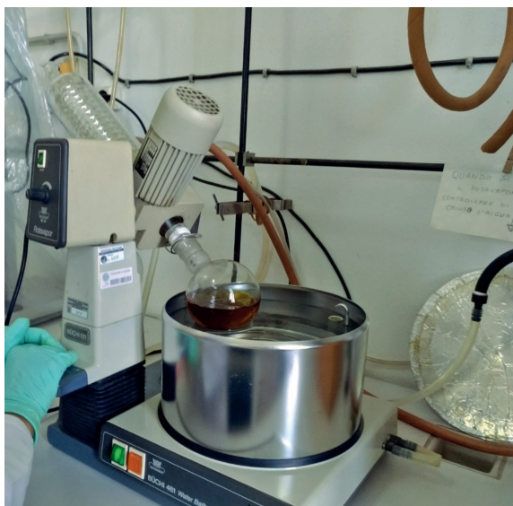
Figura 12.2 – Evaporazione di una soluzione estrattiva mediante Rotavapor.
