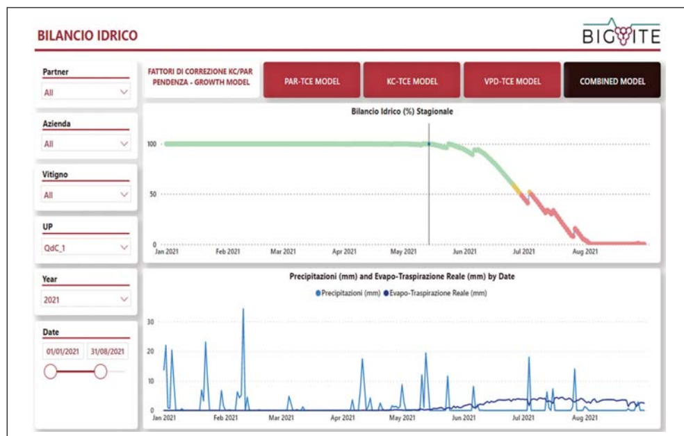
Figura 6.1 – Uno screenshot estratto dal progetto Big-VITE (PSR Regione Emilia-Romagna 2014-2020) che visualizza il cruscotto di controllo del bilancio idrico del vigneto, esclusivamente basato su dati meteo, dati di anagrafe aziendale e dati pregressi di validazione fisiologica. Ripreso da [43].
