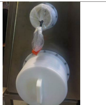
Figura 3.10 Rapid Transfer Port (RPT), Sistema di trasferimento con liner continuo
