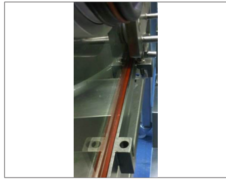
Figura 3.9 Dettaglio guarnizione gonfiabile
