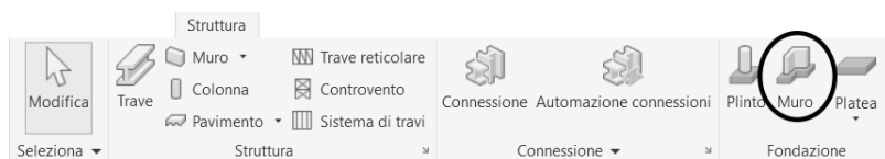
Figura 13.1 Lo strumento Muro (cordolo).
